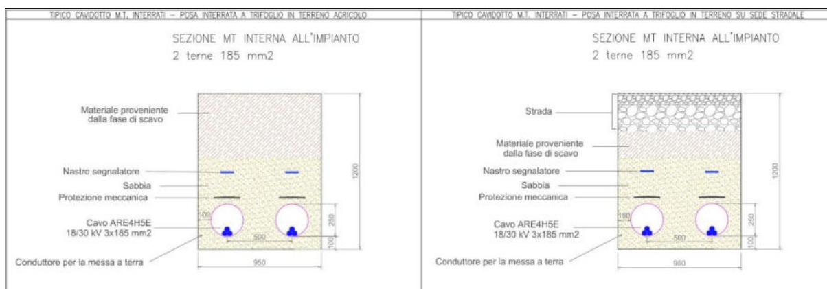
Figura 53 - Sezione scavi cavidotti 30 kV
