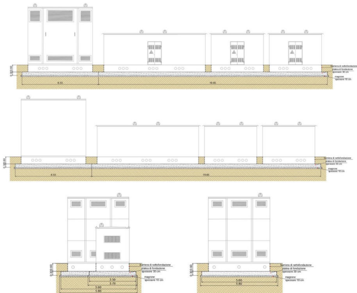
Figura 57 – Pianta e prospetti cabina di centrale
