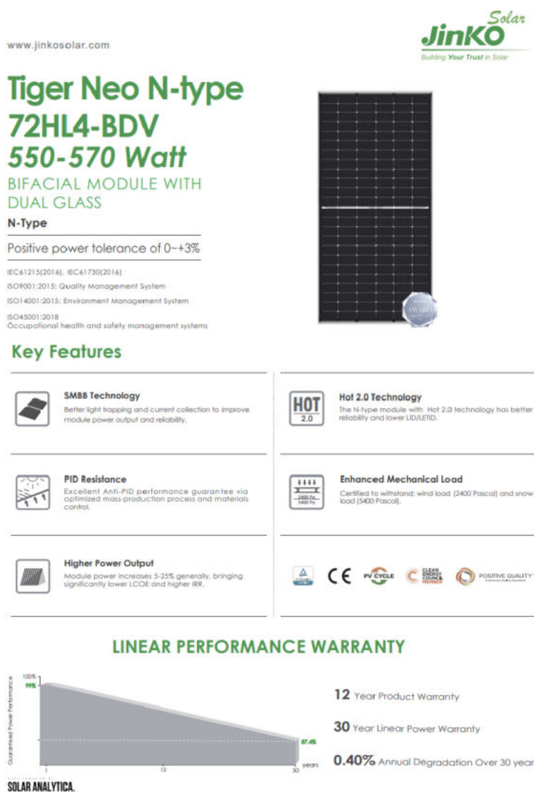
Figura 48 - Caratteristiche tecniche Modulo fotovoltaico JKM565N-72HL4-BDV
